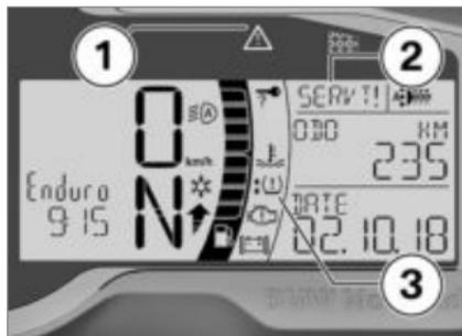
Warnungen, für die keine eigenständige Warnleuchte zur Verfügung steht, werden durch die allgemeine Warnleuchte **1** in Verbindung mit einem Warnhinweis an Position **2** wie z. B. LAMPF! oder einem Warnsymbol **3** im Multifunktionsdisplay dargestellt.
