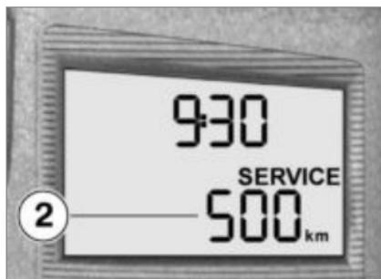
Bei hohen Jahreskilometerleistungen kann es unter Umständen vorkommen, dass ein vorgezogener Service fällig wird. Liegt der Kilometerstand für den vorgezogenen Service innerhalb von 1000 km, werden die verbleibenden Kilometer **2** in 100-km-Schritten heruntergezählt und im Anschluss an den Pre-Ride-Check für kurze Zeit angezeigt.
