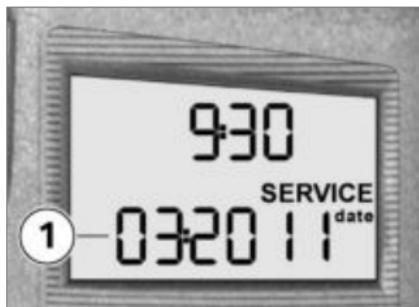
Liegt die verbleibende Zeit bis zum nächsten Service innerhalb eines Monats, wird das Servicedatum **1** im Anschluss an den Pre-Ride-Check für kurze Zeit angezeigt. Monat und Jahr werden getrennt durch einen Doppelpunkt zwei- bzw. vierstellig dargestellt, in diesem Beispiel bedeutet die Anzeige "März 2011".
