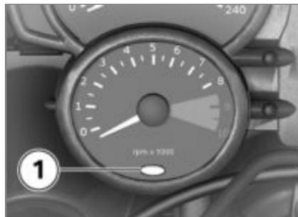
Die Drehzahlwarnung signalisiert dem Fahrer das Erreichen des roten Drehzahlbereichs. Dieses Signal wird durch das Blinken der DWA-Kontrollleuchte **1** in rot dargestellt. Das Signal bleibt erhalten, bis hochgeschaltet oder die Drehzahl reduziert wird. Es kann vom Fahrer aktiviert bzw. deaktiviert werden.
