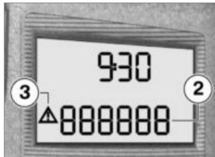
Stellt die Anzeige im Wertebereich **2** eine Warnung dar, wird dies durch das Warndreieck **3** symbolisiert. Diese Warnungen können im Wechsel mit den Kilometerzählern angezeigt werden (► 38).
