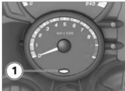
Die Drehzahlwarnung signalisiert dem Fahrer das Erreichen des roten Drehzahlbereichs. Dieses Signal wird durch das Blinken der DWA-Kontrollleuchte **1** in rot dargestellt.
