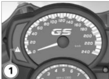
Warnungen, für die keine eigenständige Warnleuchte zur Verfügung steht, werden durch die Allgemeine Warnleuchte **1** in Verbindung mit einem Warnhinweis oder einem Warningsymbol im Multifunktionsdisplay dargestellt. Abhängig von der Dringlichkeit der Warnung leuchtet die Allge-
